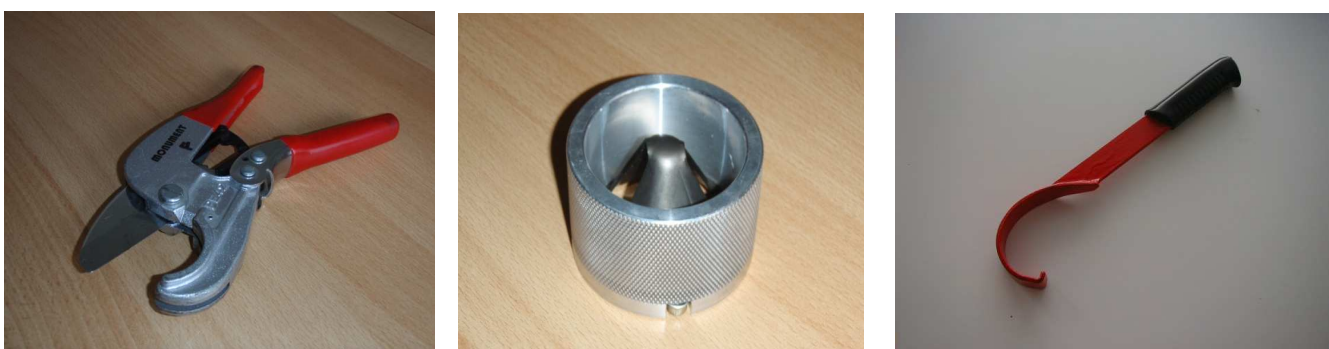
Obr. č. 4 Nožnice, „odhraňovač“ hrán na HDPE chráničkách a ťahovací kľúč na spojky
